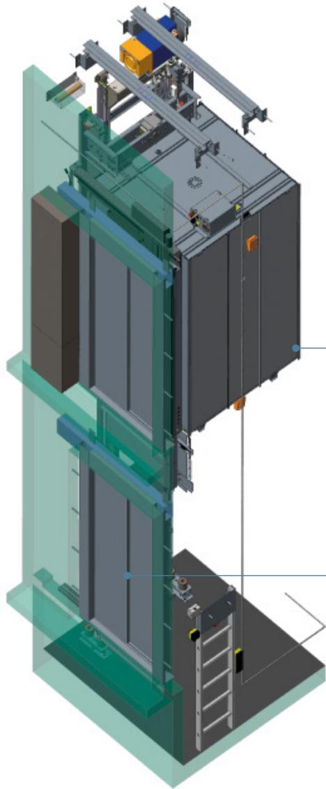
Las bases, suelos y techos de la **cabina** junto con el chasis están fabricados en chapa galvanizada de alta resistencia que aporta una gran robustez.
